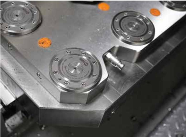
Bei den Rüstzeiten leistet umfangreiche Werkstückspanntechnik von AMF rund um starke und flache Nullpunktspannmodule einen wichtigen Beitrag
