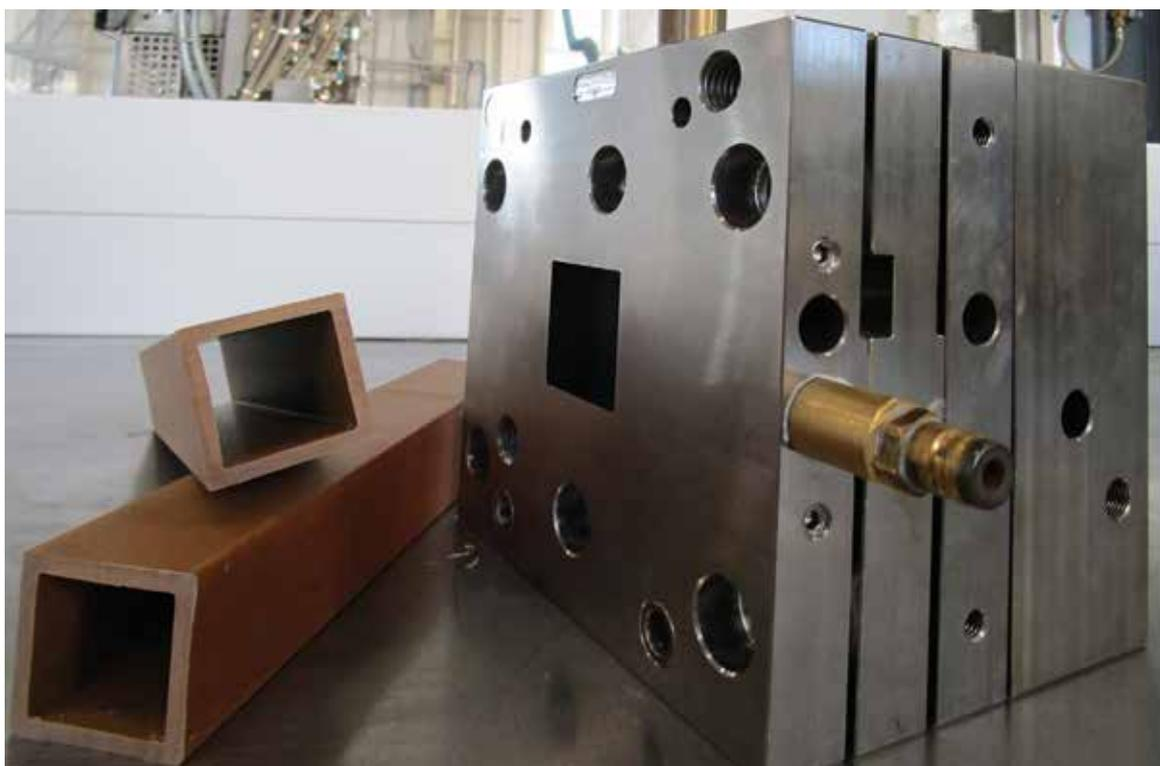
Profilwerkzeug und Musterprofile (Bild: SKZ)
