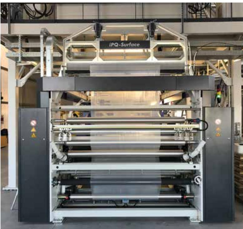
Die Inspektionssysteme der Reihe iPQ-Surface identifizieren dank modernster Technologien zuverlässig typische Fehler in der Folienextrusion und unterstützen so eine proaktive Ausschussminimierung und langfristig optimierte Herstellungsprozesse
