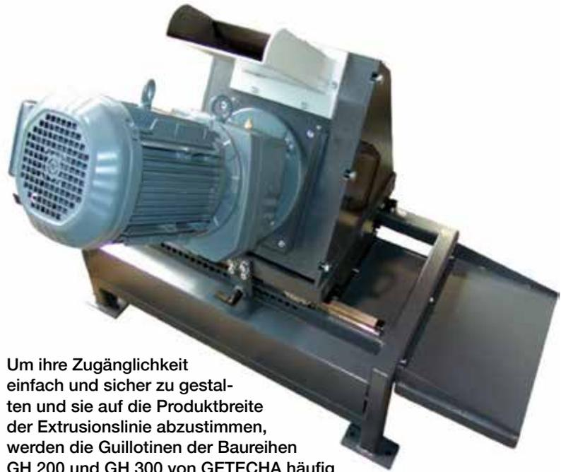
Um ihre Zugänglichkeit einfach und sicher zu gestalten und sie auf die Produktbreite der Extrusionslinie abzustimmen, werden die Guillotinen der Baureihen GH 200 und GH 300 von GETECHA häufig auf Verstelleinheiten montiert
