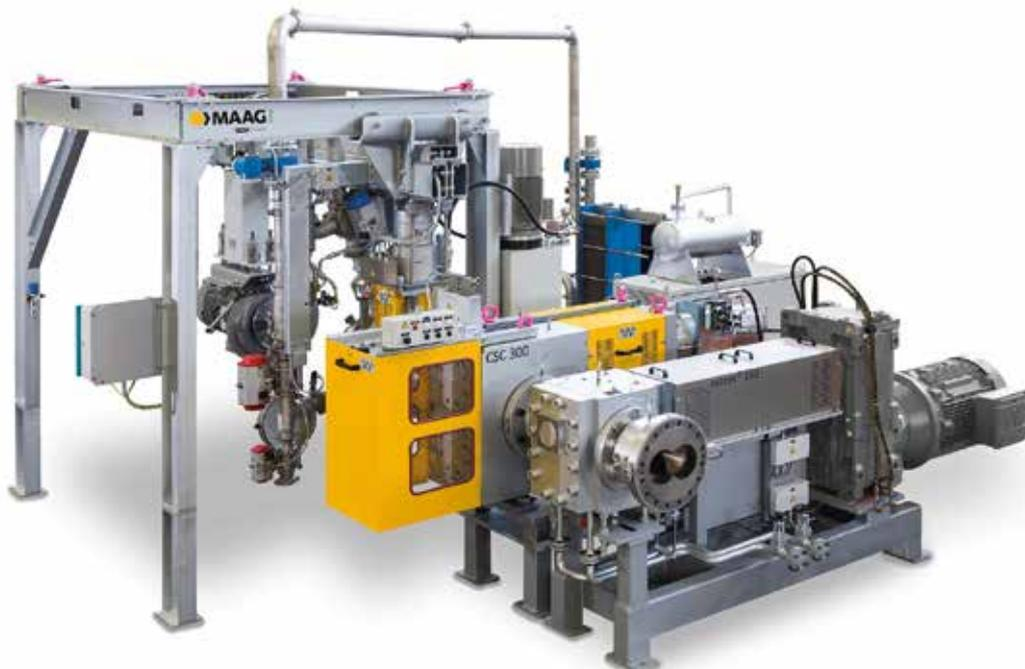
MAAG Komplettsystem aus Schmelzpumpe, Siebwechsler und Unterwassergranulierung. Die Lochplatte ist das Kernstück des Granulators und mit allerhöchster Präzision gefertigt (Bild: MAAG)
