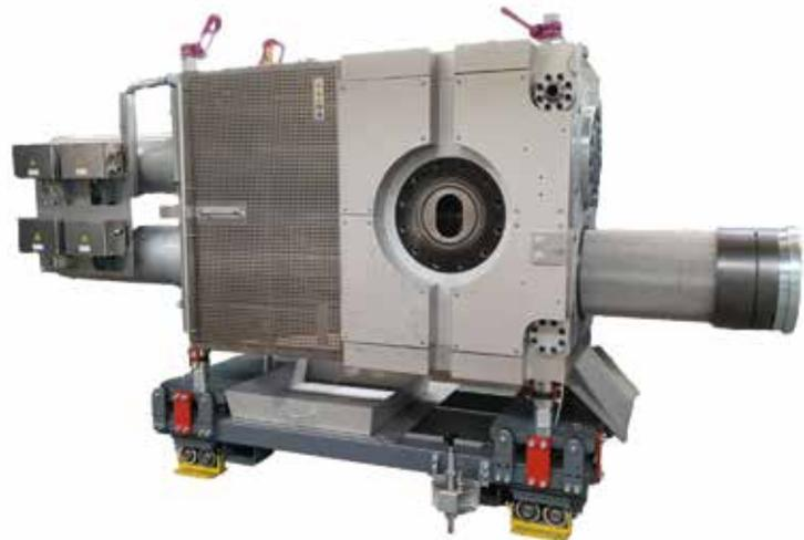
Die Doppelkolbentechnologie bei den CSC-Siebwechslern von MAAG ermöglicht einen unterbrechungsfreien Betrieb. Dank gebogener Siebe ist die Filterfläche der C-Baureihe bis zu vier Mal größer, als die der klassischen Baureihe (Bild: MAAG)
