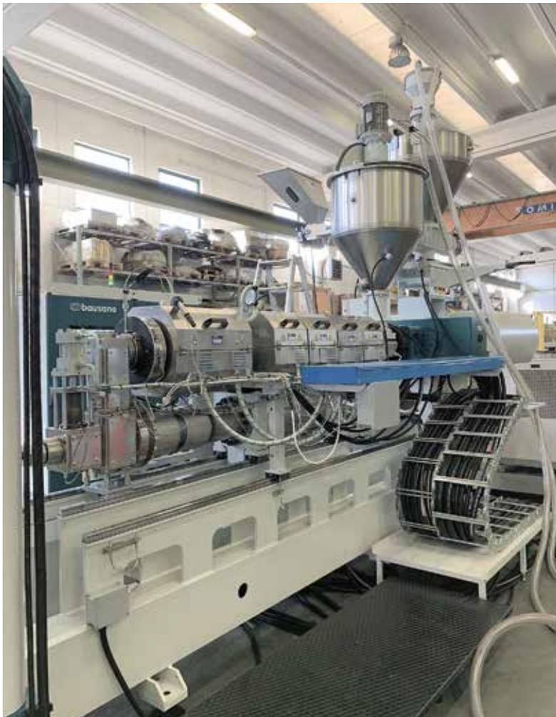
Der Bausano-Doppelschneckenextruder (oben) ist mit dem Einspritzzylinder der Wintech-Maschine verbunden
