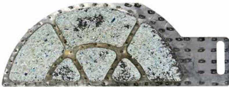
Mit rPET-verschmutzter Metallfilter vor der Reinigung
