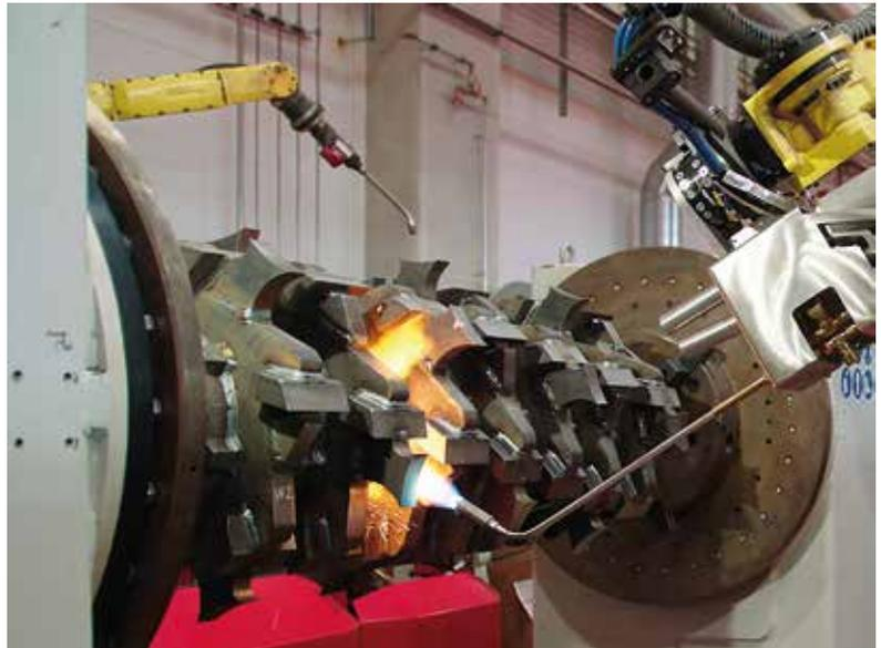
Die vollautomatische Scheibenschweißanlage wird vor allem für die Produktion der Urraco-Wellen, dem Herz der mobilen Lindner Zwei-Wellen-Zerkleinerer herangezogen. Zwei Schweißroboter sind hier 24/7 im Einsatz (Bilder: Lindner Recyclingtech)
