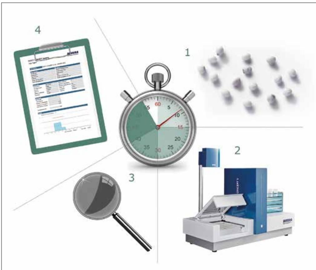
Qualitätskontrolle mit dem PURITY CONCEPT V in 1 Minute: 15 Sekunden Platzieren des Materials auf Probeträger (1), 15 Sekunden Inspektion des Materials (2), 5 bis 10 Sekunden Analyse und Detektion der Kontaminationen (3), 15 Sekunden Erstellung des Reports (4)
