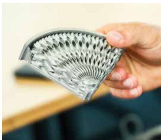
Muster einer additiv gefertigten Hochleistungskühlung für den Werkzeug- und Formenbau
