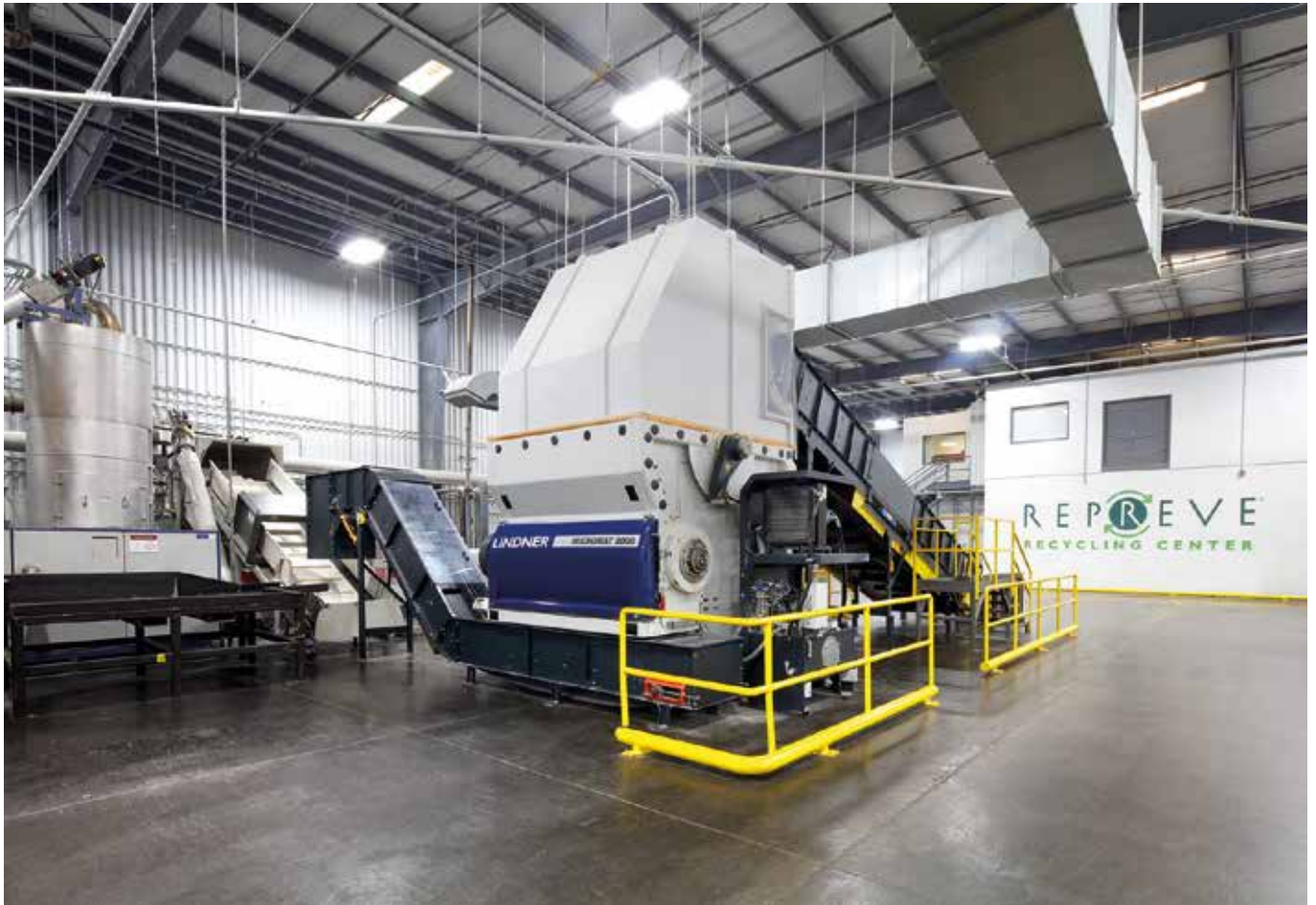
Drei Schredder der Micromat-Serie von Lindner bereiten bei Unifi, Inc. Kunststoff- und Textilabfälle für ihre Reise zur Extrusion, zum Spinnen und schließlich zum Aufwickeln der Fasern vor – und das 24/7/365
