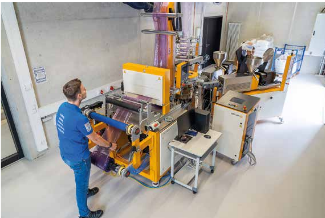
Die Blasfolienanlage am SKZ in Würzburg steht ab sofort für Weiterbildungen zur Verfügung (Bild: Luca Hoffmannbeck, SKZ)
